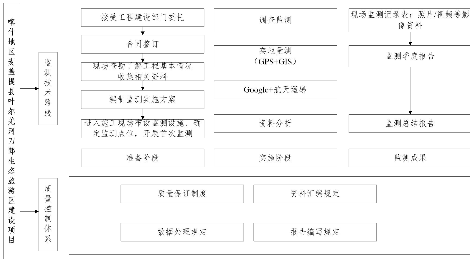
图 1-1 喀什地区麦盖提县叶尔羌河刀郎生态旅游区建设项目水土保持监测技术路线图
